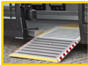
Rampe d'accès pour fauteuils roulants.
