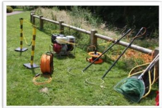
Figure 16 : Matériel utilisé pour l'inventaire de la faune piscicole. Source : Fédération de l'Oise pour la Pêche et la Protection du Milieu Aquatique.
